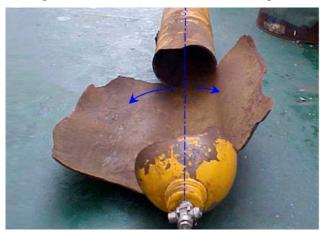
Z. 12. Eine Gasflasche, aus technischer Sicht ein Zylinderdruckgefäß mit dünner Wand, wurde längsseits ihrer Längsachse auseinander gerissen als das Ansteigen des Gasdrucks es verursachte, dass der zugelassene Grenzwert der Peripheriespannung in der Wand überschritten wurde. [8].
