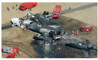
Z. 9. Die Katastrophe MD-11 in Tokio am 23.03,2009. Eine Katastrophe Typ 1B – das Flugzeug prallte auf den Erdboden und zerbrach in mehrere Teile senkrecht zur Achse.Eine Explosion zerriß dann den hinteren Teil, er hat sich der Achse entlang geöffnet.
