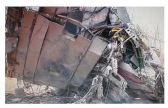
Z. 24. Das Aussehen des Fußbodens des Flugzeugs Tu-154 während des Aufhebens des Rumpfes [13]. Das Hinauswerfen der aufgerissenen Decke und der Borden des Rumpfes nach draußen und seine Umdrehung in der Luft führte zum derartigen Aufprall, dass der Fußboden vor der Aufhebung dem Untergrund angepasst war. Unter dem Fußboden gab es weder Leiche der Passagiere noch Sessel. Sichtbar sind nur die Schienen für die Befestigung der Sessel.
