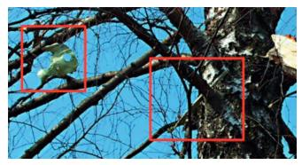
Z. 30. Fragmente des linken Flügels auf der Birke auf dem Bodin-Grundstück auf der Höhe des Durchbruchs [10]. Die "Blechvögel" mussten vom Flugzeug abgefallen sein nicht weniger als einige Dutzend Meter höher als Punkte, an denen sie hängen geblieben sind.
