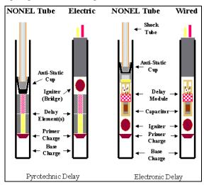
Z. 38. Die Konstruktion verschiedener Zündsätze – mit nicht elektrischem (Nonel) und elektrischem (Electric) [27] Funktionssystem.
