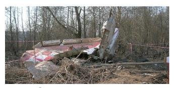
Z. 23. Der Überrest der Höhenflosse und die nahliegenden Fragmente der Seitenflössen [6]. Die fehlenden Teile der Seitenflössen sind früher abgefallen.
