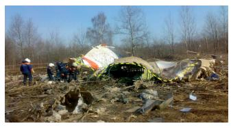
Z. 3. Der mittlere Teil des Rumpfes vom Spant 40 bis 64 [5]. Die Zerrissenheit längs des Rumpfes und die umgestülpten und nach außen herauskatapultierten Wandborde, sowie die Decke, sind der Beweis für eine starke innere Explosion. Die Zerstörung dieser Art kann nicht durch Einwirkung von Außenkräften verursacht worden sein.
