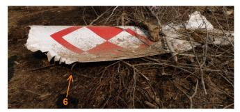
Z. 25. Das Fragment der Schutzschicht des unteren Endstücks des linken Flügels mit dem Fragment der Verkleidung der Führungsleiste der Klappe [6]. Im Hintergrund die rechte Seitenflosse (3) [17]cZ. 3. Die obere Außenhaut wurde zersplittert und ihre Stücke liegen an abgelegenen Stellen.
