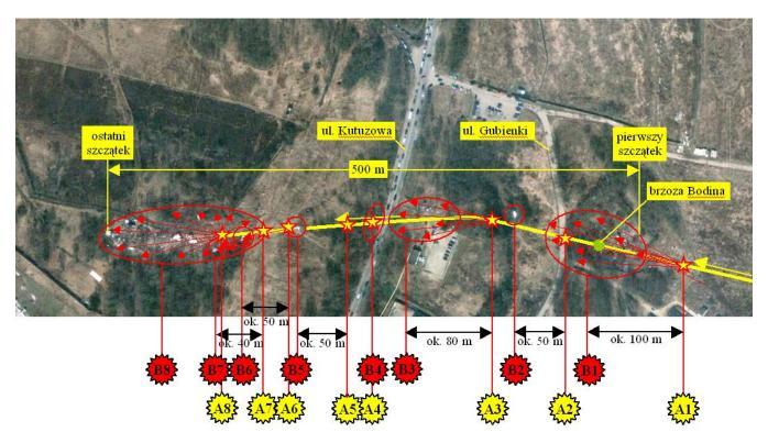
Z. 14. Die Trajektorie des Flugzeugs Tu-154 und die horizontale Verteilung der Hauptüberreste. Mit den Buchstaben B wurden die Schwerpunkte der nächstfolgenden Zonen, die mit Überresten bedeckt sind, markiert. Mit den Buchstaben A wurde der Punkt markiert, an dem ungefähr die Überreste von der Konstruktion des Flugzeugs, das mit der Geschwindigkeit ca 270 Kilometer/Stunde flog, abgerissen wurden.
